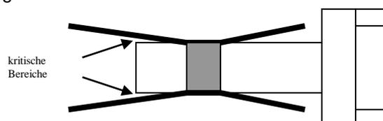
Als Befestigung zur Verbindung eines Schlauches mit der Befüllkupplung *sollten* ausschließlich die in der DVGW-Prüfgrundlage VP 550 in Anhang A aufgeführten und abgebildeten Verbindungstechniken verwendet werden.
