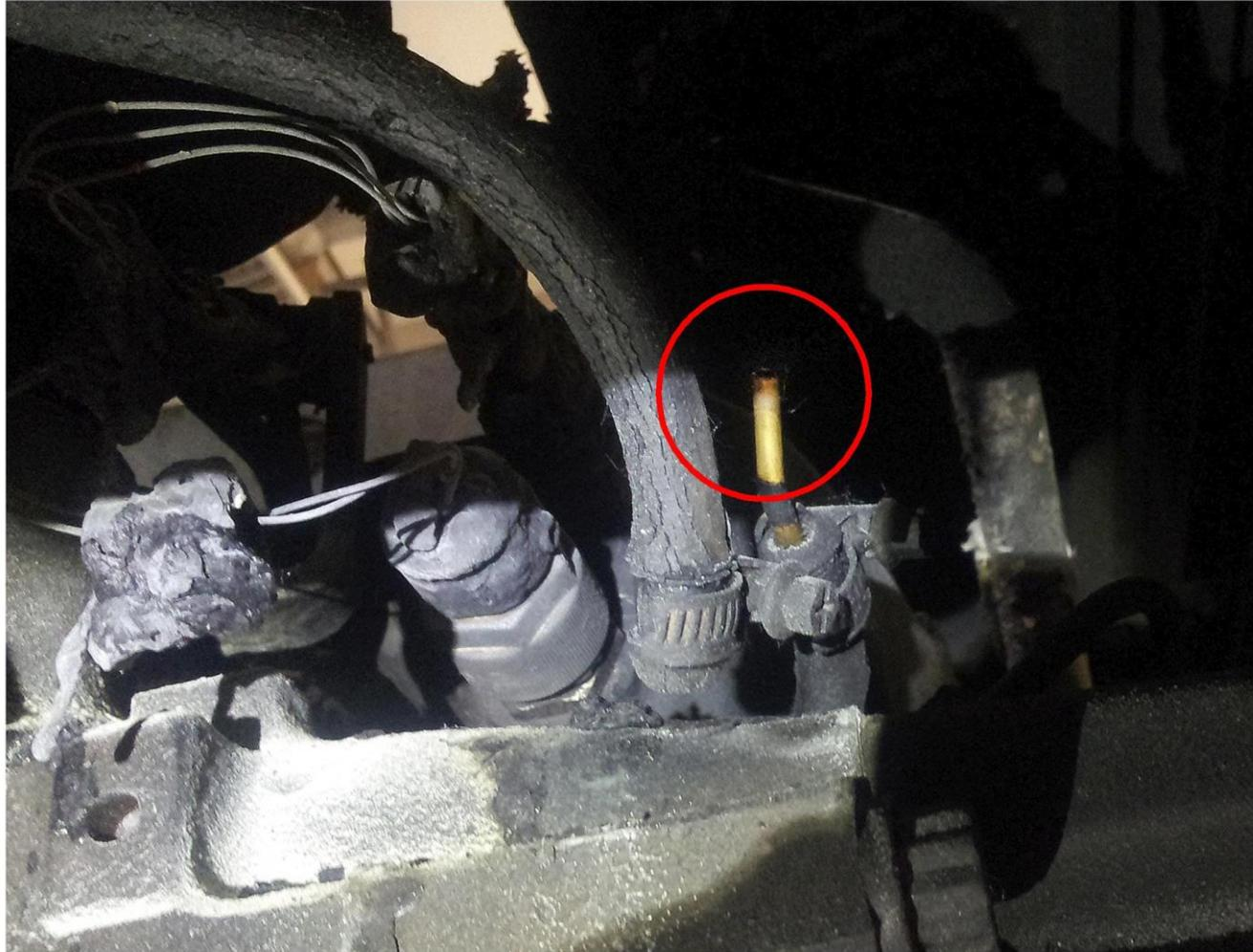
*Abbildung 7: Leckkraftstoffleitung abgezogen*
