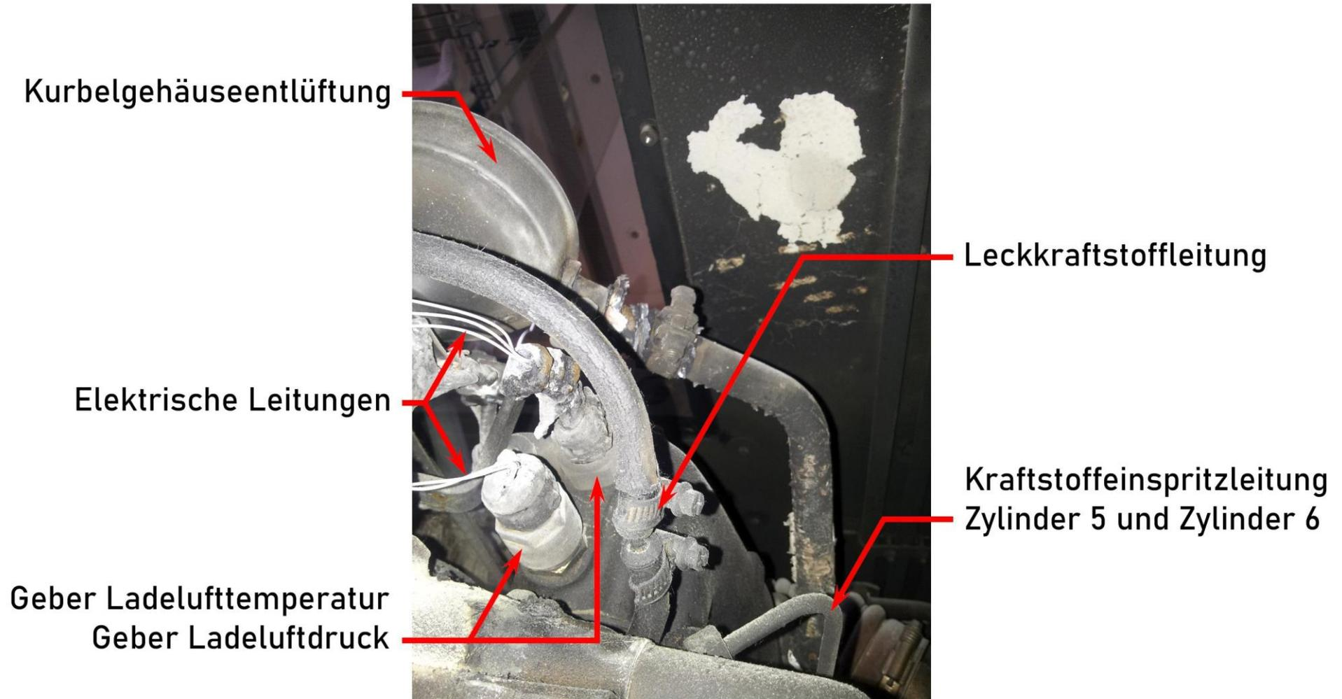
Abbildung 3: Powerpackträgerrahmen Unterseite
