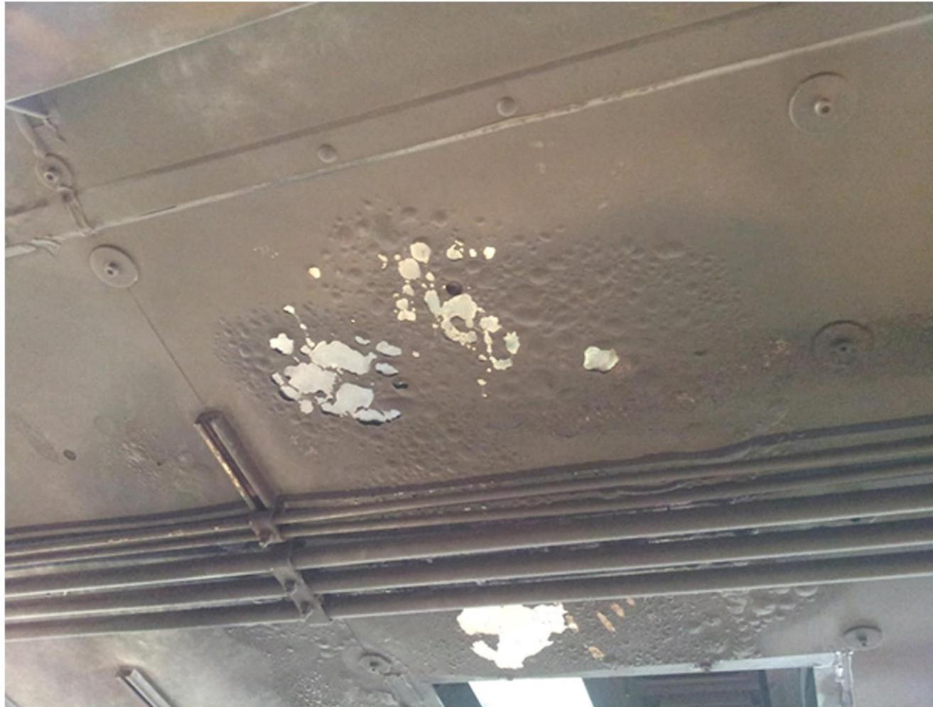
*Abbildung 4: Spuren von Wärmeeintrag an der Unterseite des Wagenbodens*
