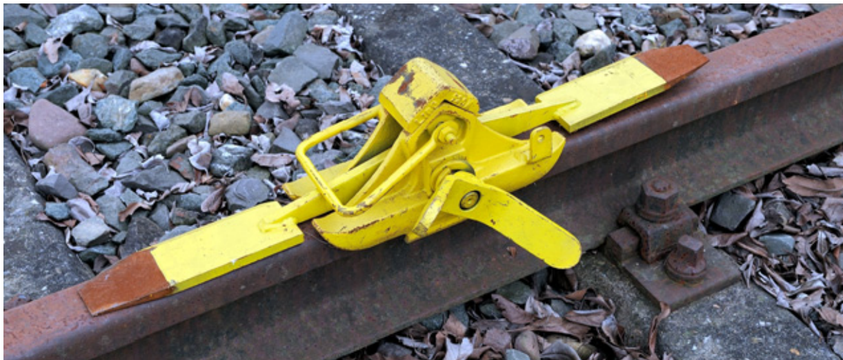
Doppelseitig wirkender Radvorleger (am Schienenkopf festschraubbar) Foto: O. Gröpler, Minden
