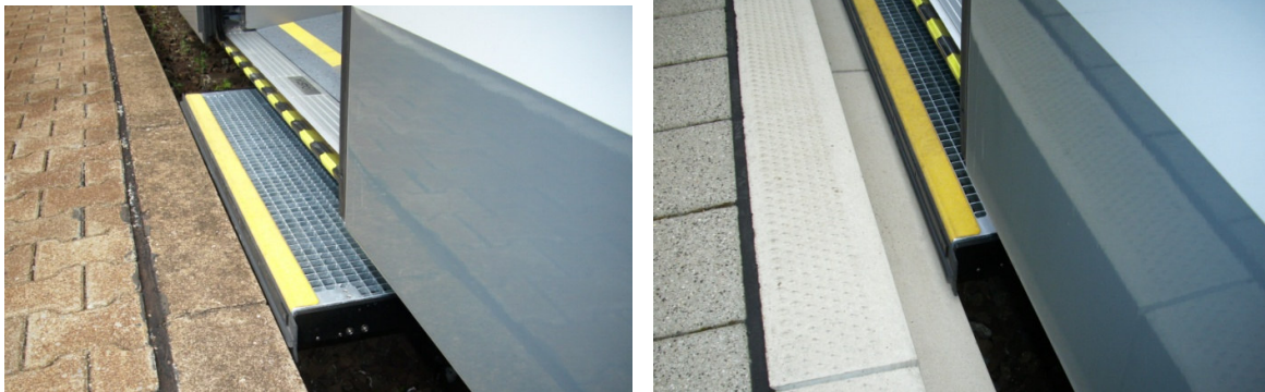
Abb. 12: Anwendungsbeispiele für die Trittausfahrweite < 150 mm
