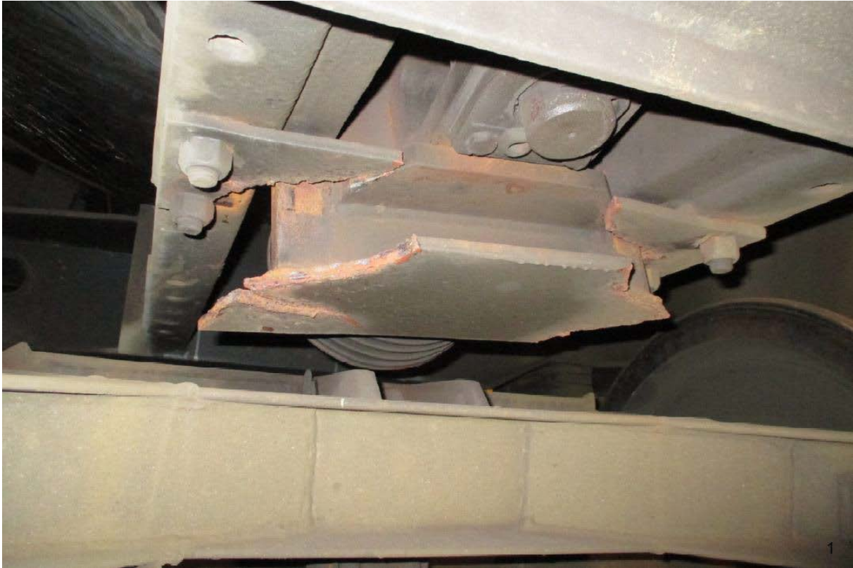
Bild 2: vollständig durchgebrochene Grundplatte
