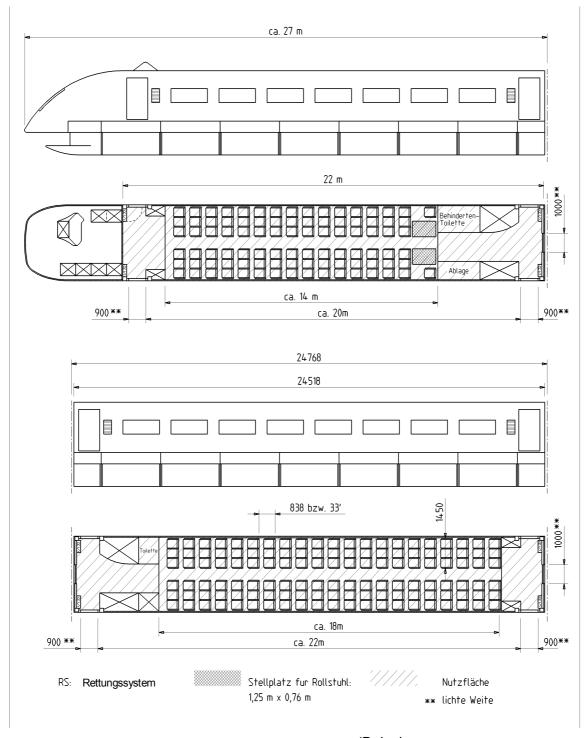
Abbildung 6: Fahrzeugsektionen für Personentransport Fernverkehr (Beispiel)
