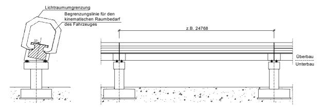
Abbildung 19: Aufgeständerter Fahrweg (Beispiel)
