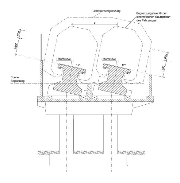
Abbildung 29: Schallschutzwand am aufgeständerten Fahrweg (Beispiel)
