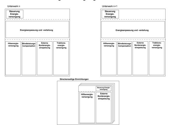
Abbildung 13: Struktur der Energieversorgung (Beispiel)
