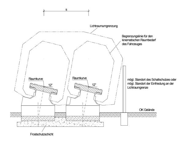
Abbildung 28: Schallschutzwand und Schutzzaun am ebenerdigen Fahrweg (Beispiel)
