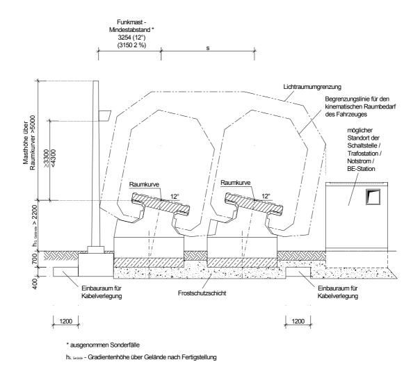
Abbildung 30: Streckenperipherie bei ebenerdigem Fahrweg (Beispiel)
