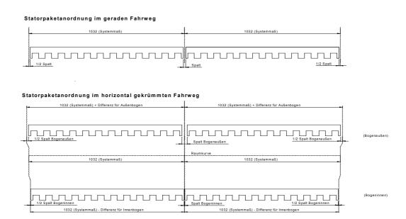
Die Längen der einzelnen Statorpakettypen müssen projektspezifisch festgelegt werden. Abbildung 23: Statorpaketanordnung (Beispiel)
