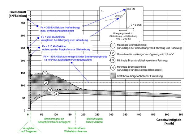
Abbildung 10: Bremskennlinie sichere Bremse für eine MSB-Fahrzeugsektion
