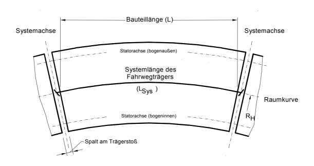
Abbildung 21: Trägermaß - Zusammenhang Bauteillänge/ Systemlänge
