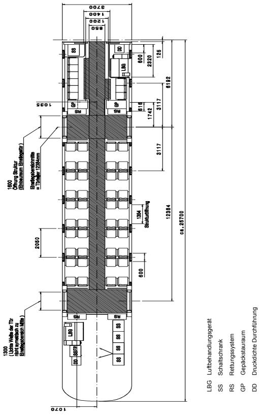
Abbildung 7: Fahrzeug-Endsektionen für Personentransport Flughafenanbinder (Beispiel)
