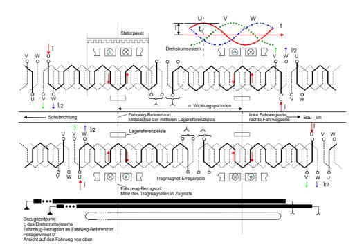
Abbildung 5: Zuordnung Wicklungsstränge, Referenzort, Erregerpole
