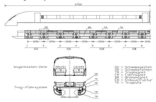
Abbildung 9: Trag-/ Führsystem (Beispiel)
